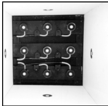
(b) 광덕트 축소모형의 바닥과 벽면에 설치된 조도센서
