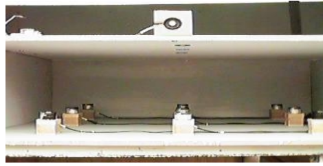
그림 9. 모형에 설치된 조도센서 사진
