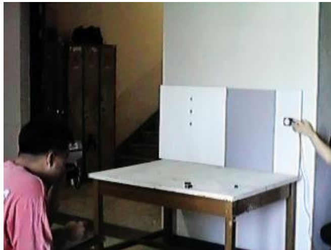
[그림 4.1.9] 조도계와 휘도계를 사용하여 반사율을 측정하는 장면
