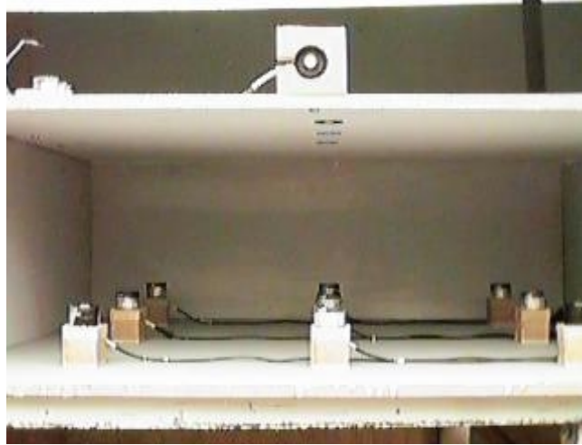
[그림 4.1.6] 사무실 축소 모형에 설치된 조도센서
