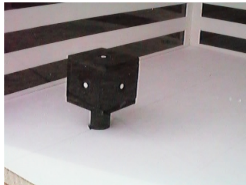
[그림 4.2.1] 3 차원 공간조도계 개념도 [그림 4.2.2] 3 차원 공간조도계의 실제 모습
