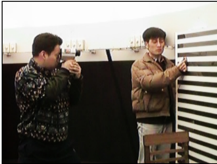
[그림 4.2.11] 조도계와 휘도계를 사용하여 반사율을 측정하는 장면
