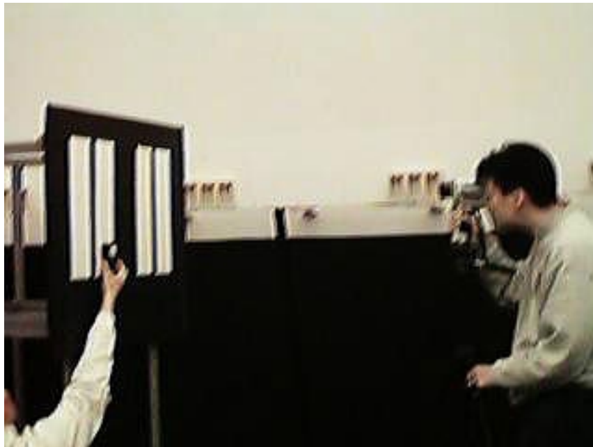
[그림 4.1.6] 조도계와 휘도계를 사용하여 반사율을 측정하는 장면
