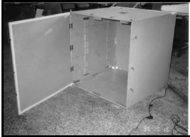
(a) 바닥판을 끼워서 실내 공간의 높이를 변화시킬 수 있도록 제작된 모형의 모습
