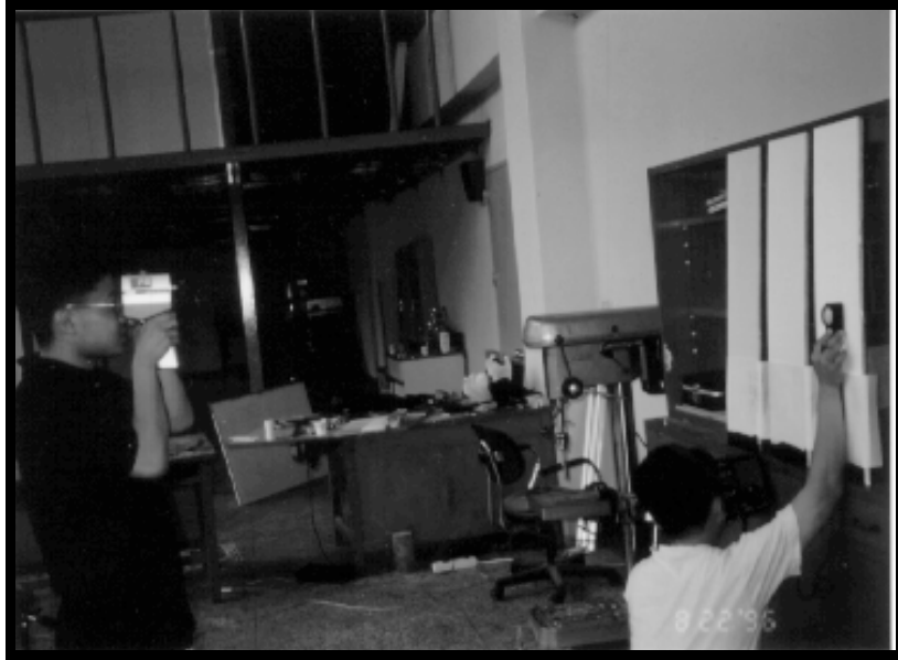
[그림 4.2] 조도계와 휘도계를 사용하여 반사율을 측정하는 장면
