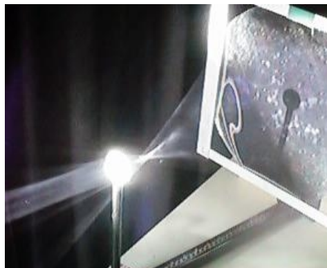
[그림 4.2.1] 한 개의 오목거울과 한 개의 수렴렌즈를 이용한 집광 실험
